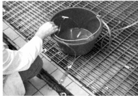
لوله های نمونه برداری را در یک ظرف قرار داده و شیر نمونه برداری ترانس را باز کنید. حداقل سه بار شیر و لوله ها را با روغن ترانس شستشو دهید.
