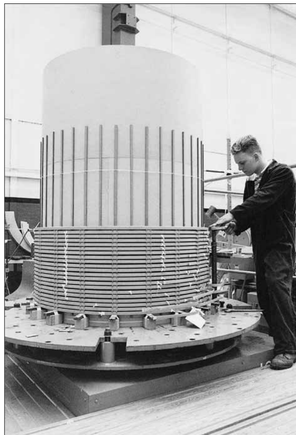
شکل ۴-۲۰: سیم پیچی بر روی ماشین عمود پیچ (شرکت پیل ترانسفورمر)
