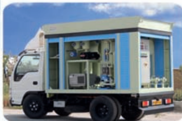
دستگاه تصفیه روغن ترانسفورماتور
