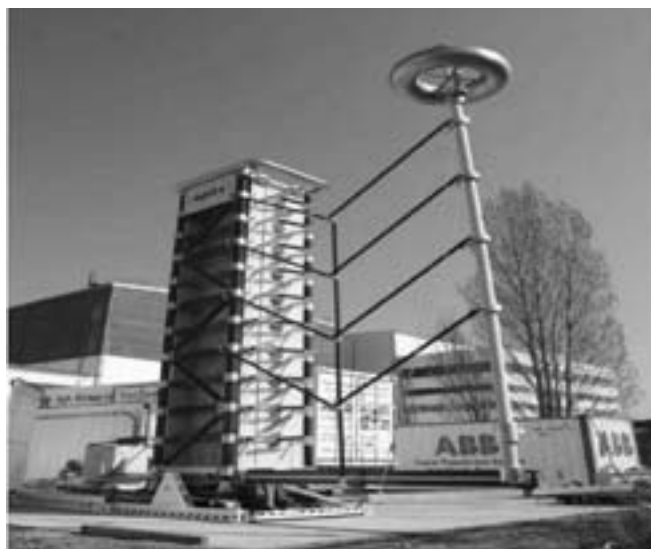
شکل هشت: مدار نهایی برای تست ضربه
