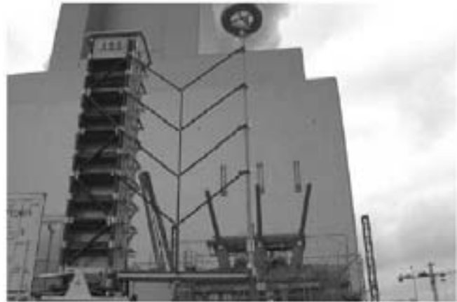
شکل نه نمایی از انجام تست ضربه در محل یک نیروگاه
